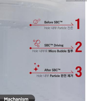
Super Bubble Clean(SBC™)은 다수의 미세한 홀 내부의 Particle 세정을 위한 전용 세정 장치입니다. 반도체 공정에서 사용되는 부품의 홀 내부는 공정상 미세 식각 및 반응 부산물로 표면 거칠기가 균일하지 못하게 되며, 또한 세정액과 모재의 표면 장력 등에 의해 세정액이 미세한 틈 사이로 침투가 원활하지 않게 됩니다. 일반적 침적 방식의 세정은 Particle을 완벽히 제거 불가능하며, Chamber 장착 시 다량의 Particle이 발생됩니다.
